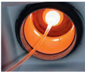
Abb. 2-46a und b: Foto und schematische Darstellung des Vello-Röhrenzugs. (Quellen: Nipro Glass France (a) und Nipro Glass Germany AG (b))
